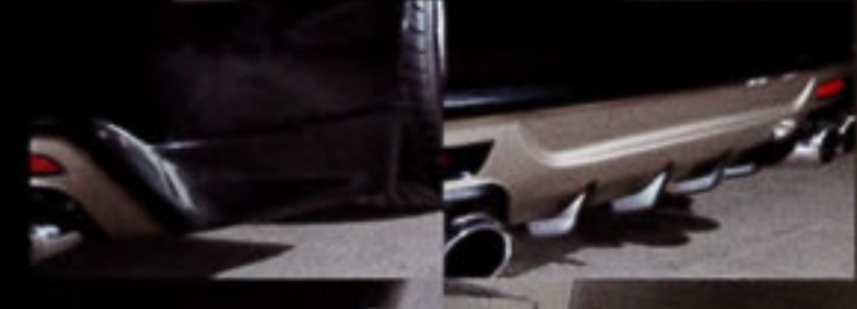
リアは純正アンダーパネルを外し、被せて装着するハーフタイプ。中程まで到達するディフューザー面が、のっぺり感を完全に払拭する。
