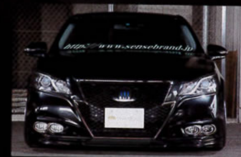
フロントは純正ホムラインに沿って装着するリップタイプ。大ききにはバンパーから下にプラス25ミリ程。走りには支障を来さないサイズ。
