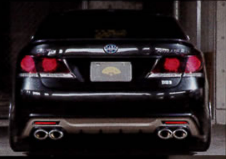
リアは純正アンダーパネルを外し、被せて装着するハーフタイプ。中程まで到達するディフューザー面が、のっぺり感を完全に払拭する。
