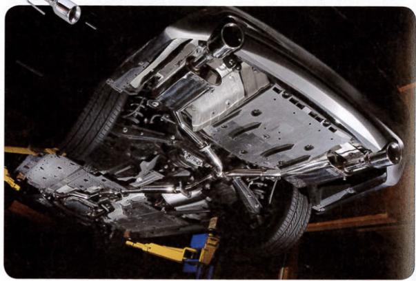
タイヤに響かせる除いた箇所も注意。リアピースト交換してしまおう。センターパイプにあるクワとしたタイヤ。社外では薄型に置き換わる。分厚い触媒は、フロアアリの出っ張っているため間違いなく接触する。
