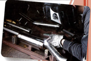
経験豊かなベテランスタッフが手作業で作り出すセンスブランドのマフラー。溶接方法にもこだわり、高品質かつ美しい溶接跡を実現できるティグ溶接を採用している。
