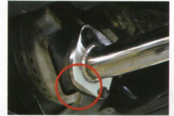
↑触媒からつながるフロントパイプのフランジ部に注目。底面に切れ込みを入れ、クリアランスを確保している
