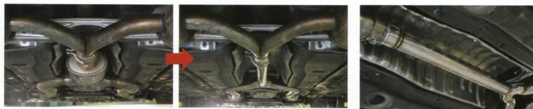
↑車体後方から見たフロントパイプと触媒。ステルスを装着すると、フレームより高い位置にすべてが収まるのがわかる
