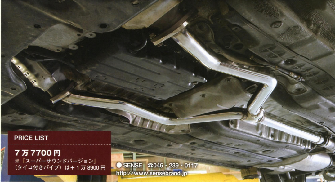
↑フランジに付けたこの角度が、触媒の向きを補正してくれる
