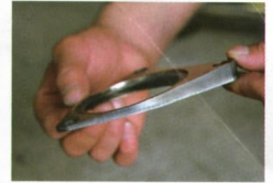
↑フランジに付けたこの角度が、触媒の向きを補正してくれる
