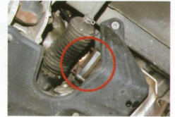
↑エキマニと触媒の間に装着した状態。銀色の部分がステルスフランジだ
