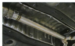
↑ストレート仕様のフロントパイプ。タイヤ付きの「スーパーサウンドバージョン」は、パイプ底面の位置は変えずにパイプ上のクリアランスにタイヤが付く
