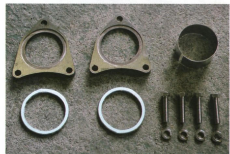
↑触媒からつながるフロントパイプのフランジ部に注目。底面に切れ込みを入れ、クリアランスを確保している
