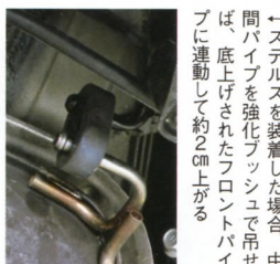
↑ストレート仕様のフロントパイプ。タイヤ付きの「スーパーサウンドバージョン」は、パイプ底面の位置は変えずにパイプ上のクリアランスにタイヤが付く
