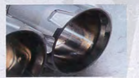
↑アルミ素材とステンレス素材のドッキングは、しっかり径を合わせてフィッティング。内部は鏡面仕上げとしている。このていねいな仕事ぶりは、センスブランドならではのクオリティー。
