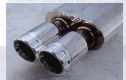
↑サイレンサー付きのバージョンも用意されており、サウンドチューニングも可能。写真のタイプは平型サイレンサー。これ以外に重低音を実現する砲弾型のチャンバー室内臓サイレンサーも用意されている。
