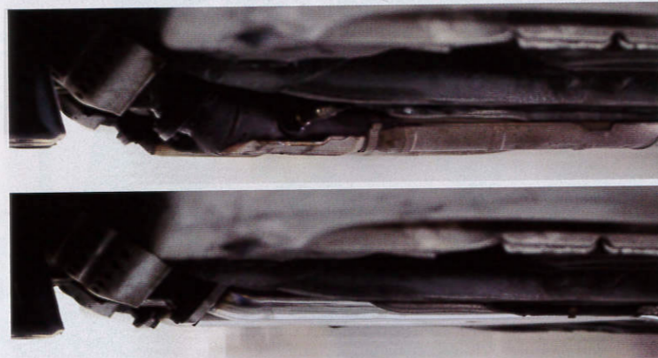
↑20系セルシオ用フロントパイプ、スーパーサウンドバージョン。パイプ底面の高さを変えずにタイコを装着している。
